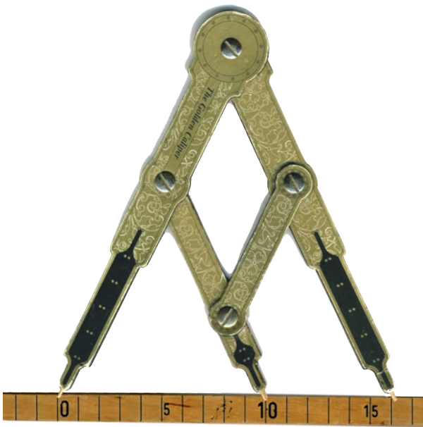
Abb. 5: Der Goldene Zirkel, wie er wohl vor 130 Jahren ausgesehen hat. Hier haben wir den Zirkel so eingestellt, dass der linke Schenkel auf der 0 und der mittlere auf der 10 des Maßstabs liegt. Der rechte Schenkel zeigt dann (theoretisch) exakt auf die 16,18.
